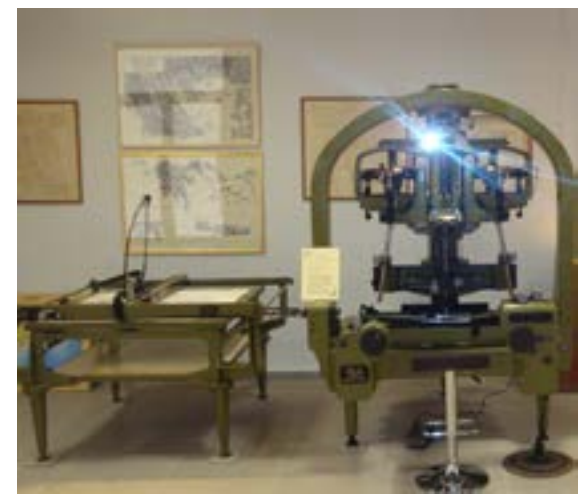
43. Στερεο-αναγωγικό όργανο οπτικομηχανικής προβολής WILD A5 έτους παραλαβής 1938. Συνοδεύεται από τράπεζα σχεδίασης
